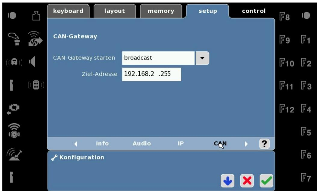
Wenn Sie am PC einen Firewall aktiv haben, dann muss die Kommunikation mit der CS2 hier wahrscheinlich auch extra freigeschaltet werden. Die CS2 braucht 2 IP-Ports, die für die IP-Adresse der CS2 im Firewall freigeschaltet werden müssen, es sind die Ports 15730 und 15731.
