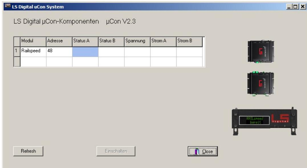
In der Tabelle können die Ausgänge der Booster ein- und ausgeschaltet werden mit der „Einschalten“-Taste. Hierzu wählen Sie zuerst in der Tabelle den Ausgang und drücken dann die Taste.
