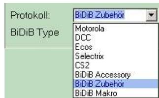
OpenDCC kennt 3 verschiedene Schaltbefehle: Accessory (Weichen und Signale), Zubehör und Makro. Der Decoder kann 1 oder mehrere von diesen Schaltbefehle erkennen und ausführen. Der Lightcontrol z.B. kennt alle Schaltbefehle. Bei den Eigenschaften der Magnetartikels wird im Feld „Protokoll“ angegeben, ob ein Schaltbefehl als Accessory, Zubehör oder Makro ausgegeben wird.
